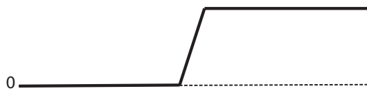
Figur 2.2: En schematisk bild av residualsignalen. När ett fel uppstår kommer signalen att bli nollskild.
