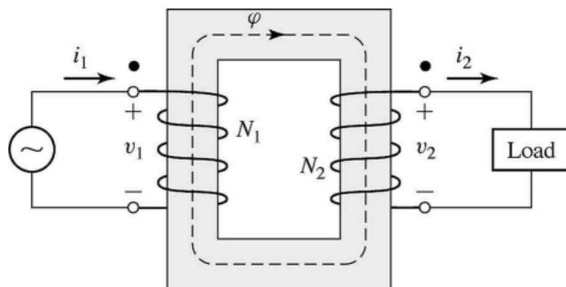
Punkterna markerar terminaler av motsvarande polaritet, dvs matas lindningarna med ström in i punkterna samverkar de resulterande mmk:erna.
