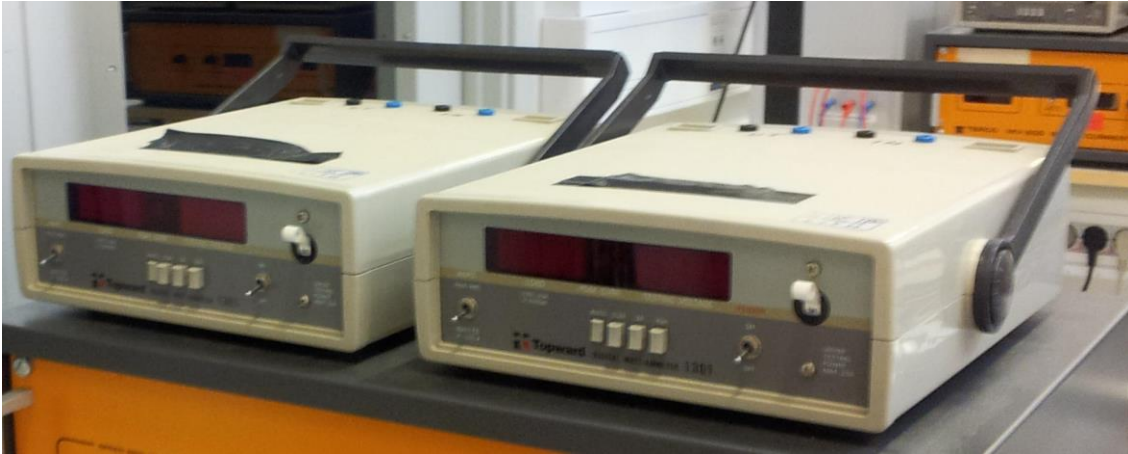
Figur 6 Wattmetrarna som ska användas vid experimenten.
