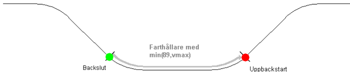
Figur 7.3: Styrningen då lastbilen befinner sig vid Backstart och därefter ska ta en uppförsbacke.
