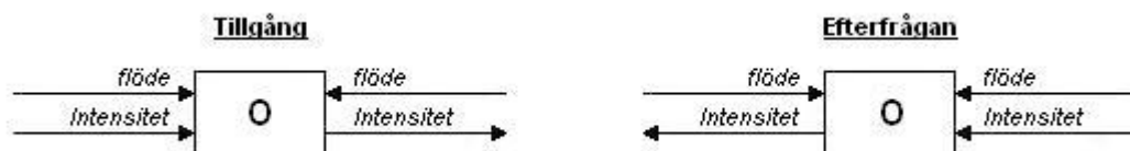
Figur 43. Byggelement för energiomvandling. För element som utgör en energitillgång är effekten ut mindre än effekten in. Det omvända förhållandet gäller för element som har en efterfrågan på energi.
