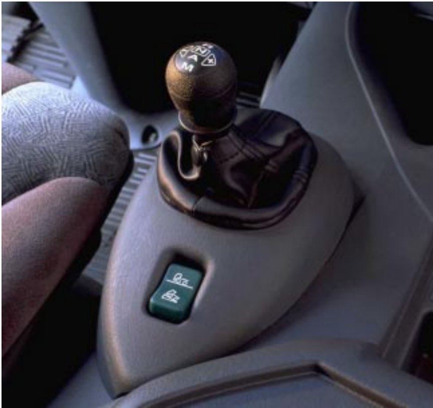
Figur 3.1. OptiCruise växelspak i lastbil. Notera hillknappen nertill.
