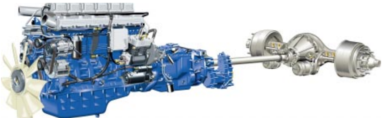
Figur 3.2. Exempel på drivlina med 12-liters motor och växellåda GRS900R med retarder.
